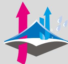
El recubrimiento está diseñado para proteger la palma de la penetración de líquidos y a su vez permite transpirar a la piel.
